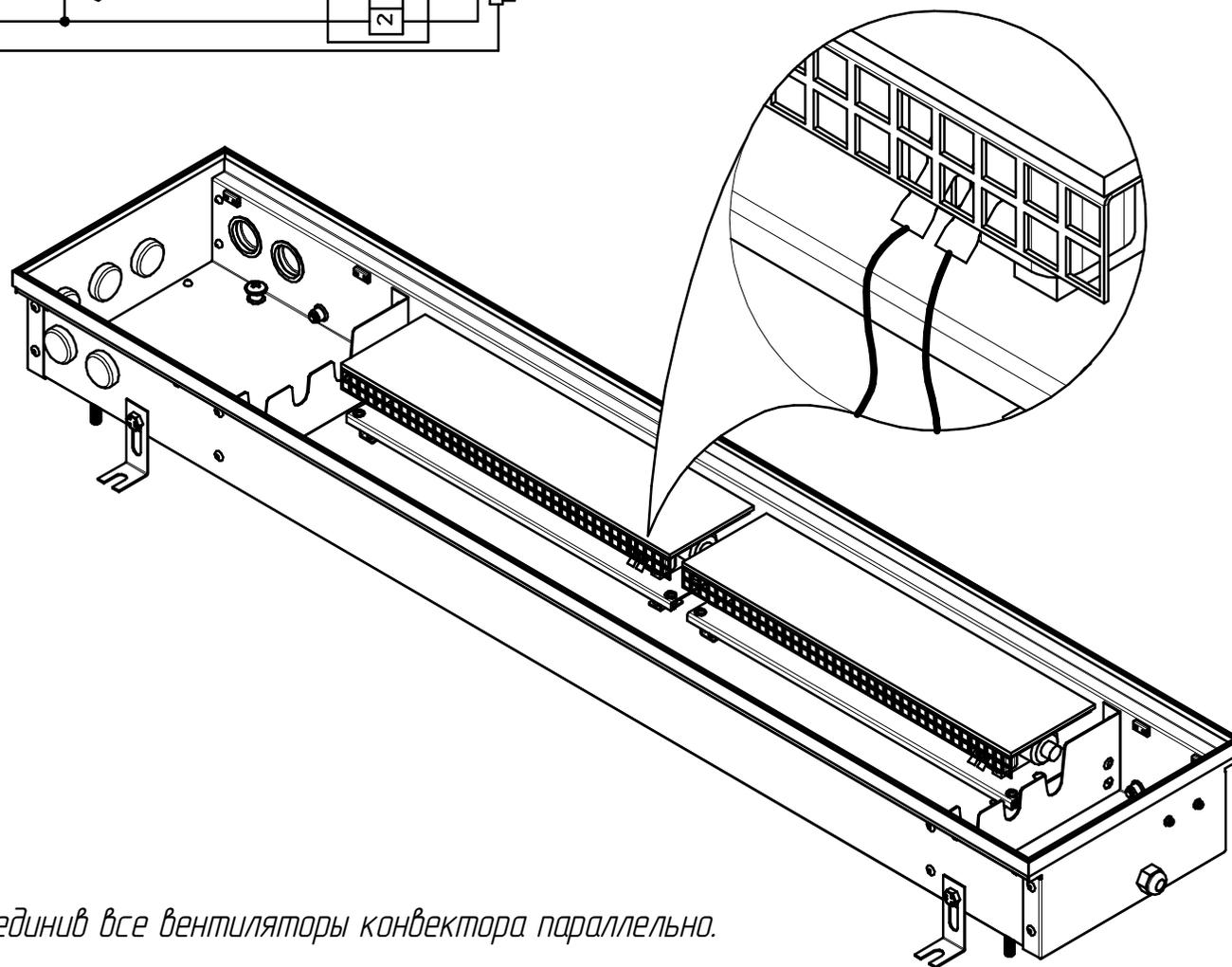
1. Произвести электрический монтаж, соединив все вентиляторы конвектора параллельно.
