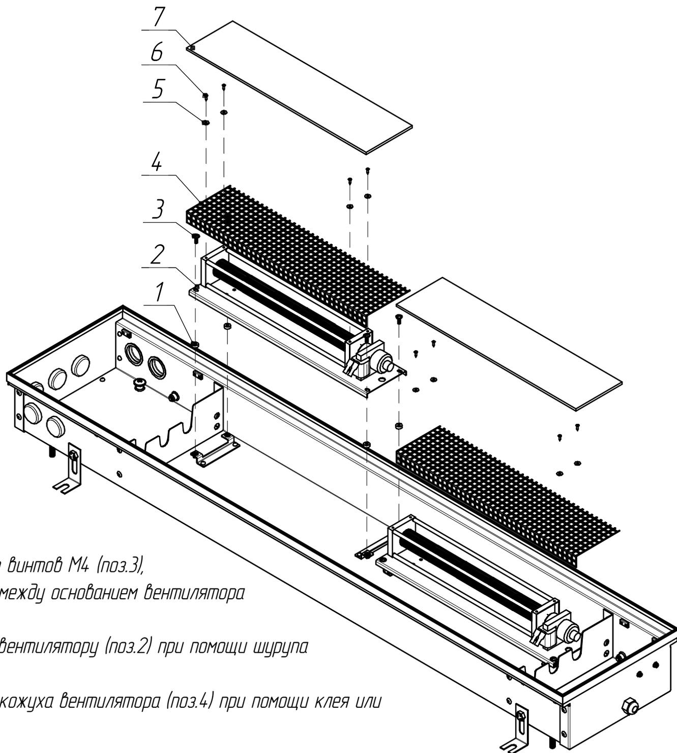
1. Крепить вентилятор (поз.2) с помощью винтов М4 (поз.3), установив резиновые прокладки (поз.1) между основанием вентилятора (поз.2) и кожухом конвектора.
